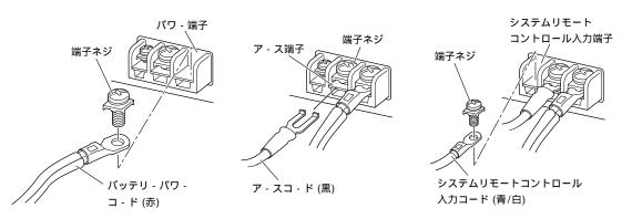
バッテリーなどの配置によりバッテリーパワーコードを高温となる場所に配置する場合は,RD-226(別売)に付属のコルゲートチューブでバッテリーパワーコードを保護し配置してください.
