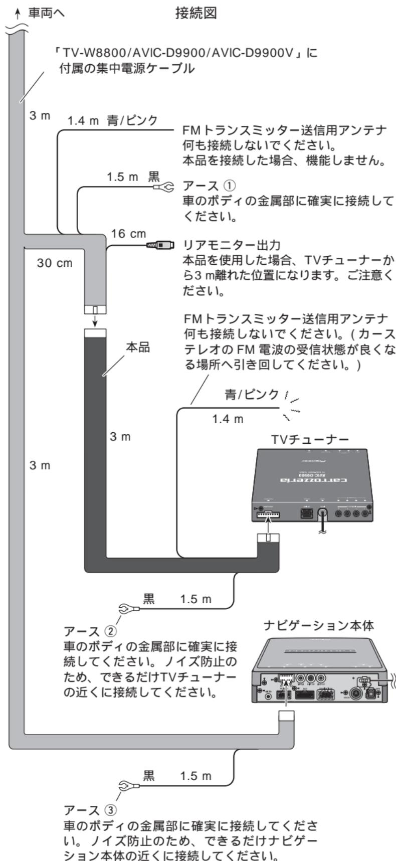
黒リード線(アース ①、②、③)は、必ず3ヶ所全て車のボディの金属部に確実に接続してください。
