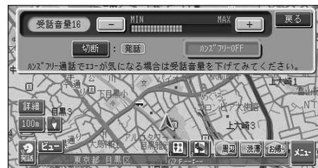
ハンズフリー ON (OFF) ハンズフリー機能を ON/OFF します。携帯電話で通話したいときに、OFF にします。 (Bluetooth 接続時のみ)
