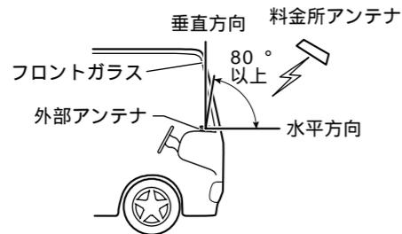
外部アンテナの前後取り付け位置は、料金所アンテナからの電波を受信するために、水平方向を基準として上方向に80°以上の範囲に障害物がない位置に取り付けてください。
