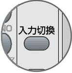
CATVチューナーを接続した端子に合わせて外部入力(L1/L2/L3)を選択します。CATVチューナーを入力3端子に接続したときは[L3]を選択します。
