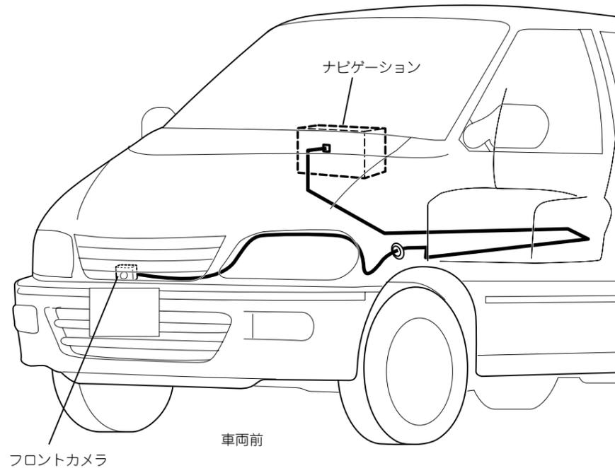
注：フロントカメラのコードは、高温に上昇する車両の装置に接触しないようにしてください。
