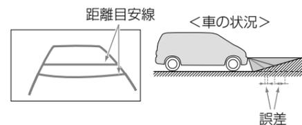
距離目安線は、平らな路面に対しての距離の目安を示しています。そのため、上り坂が後方にあるときには、実際の距離より手前に距離目安線が表示されます。例えば、上り坂に障害物があった場合は、実際より遠くにあるように見えます。同様に距離目安線と実際の路面上の進路にも誤差が生じます。
