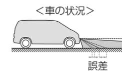
乗車人数、積載量などにより車が傾いているときは、実際の距離、進路に誤差が生じます。
