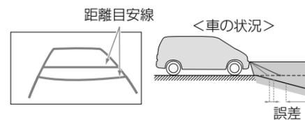
下り坂が後方にあるときには、実際の距離よりも後ろに距離目安線が表示されます。下り坂に障害物があった場合には、実際より近くにあるように見えます。同様に距離目安線と実際の路面上の進路にも誤差が生じます。
