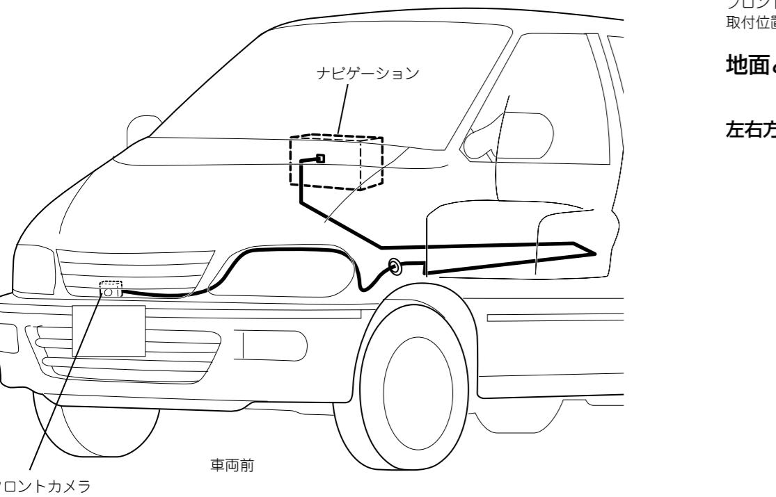
注：フロントカメラのコードは、高温に上昇する車両の装置に接触しないようにしてください。
