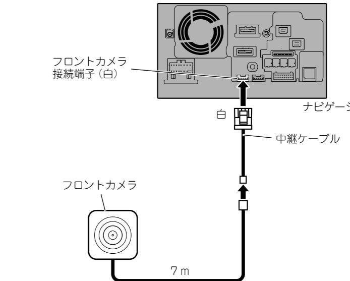
注：カメラ接続ケーブルに他の機器のリード線を接続しないでください。
