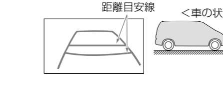
距離目安線は、平らな路面に対しての示しています。そのため、上り坂が斜には、実際の距離より手前に距離目安線です。例えば、上り坂に障害物がある際より遠くにあるように見えます。同線と実際の路面上の進路にも誤差が生じます。
