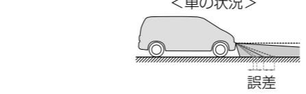
乗車人数、積載量などにより車が傾くことは、実際の距離、進路に誤差が生じる。
