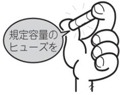
ヒューズを交換するときは、必ず表示された規定容量のヒューズをご使用ください。規定容量以上のヒューズを使用すると、火災の原因となります。
