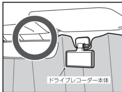
サンシェードを使用する際はドライブレコーダーを車室内側に設置してください。
