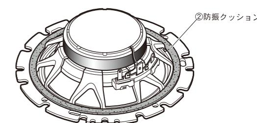
※ブラケットおよびスピーカーに防振クッション②を貼る際、クッションの合わせ目に隙間がないように2mm～3mm重ねてください。
