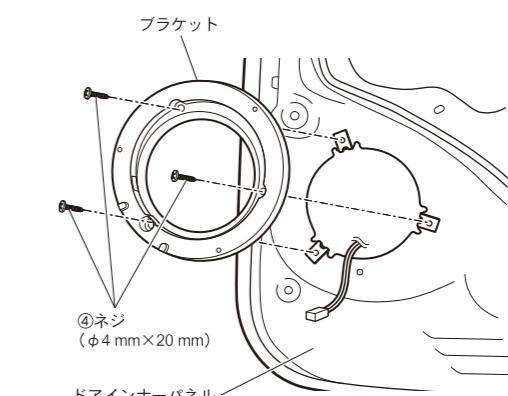
※ブラケットを取付ける際↑⑥のマークが上（水抜き穴が下）になるようにして取付けてください。（運転席側）
