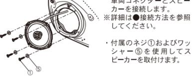
・付属のコードを使用し、車両コネクターとスピーカーを接続します。
