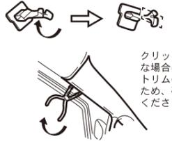
クリップの回転が不十分な場合はトリム装着時にトリムの浮きが発生するため、確実に回転させてください。
