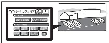
高速道路のサービスエリアや道の駅などの施設で、付近の観光情報や施設情報などを提供するサービスです。ETC2.0のインターネット接続機能を利用して提供されます。例えば、受信したメニュー画面をナビゲーションで操作して観光情報などを閲覧できます。
