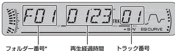
\* マルチCDプレーヤーでCDを再生しているときは、ディスク番号 (例「D01」) が表示されます。内蔵CDプレーヤーで通常のCDを再生しているときは、何も表示されません。
