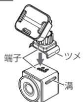
GPSユニットのツメとドライブレコーダー本体の溝を合わせ、それぞれの端子の位置が揃っていることを確認したら「カチッ」と音がするまでしっかりと取り付けてください。
