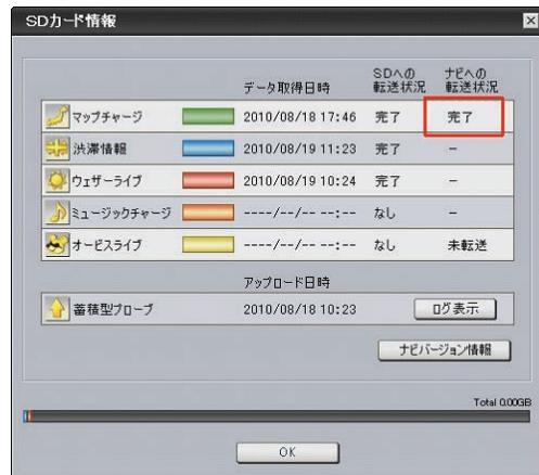
「未転送」と表示されている場合は、カーナビゲーションのバージョンアップが完了していません。P.15～P.16「ステップ6 カーナビゲーション本体のバージョンアップ」の手順に従ってカーナビゲーションをバージョンアップしてください。
