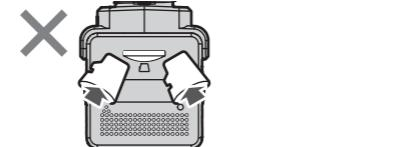
△ microSD カードを斜めに挿入しないでください。破損の原因になります。
