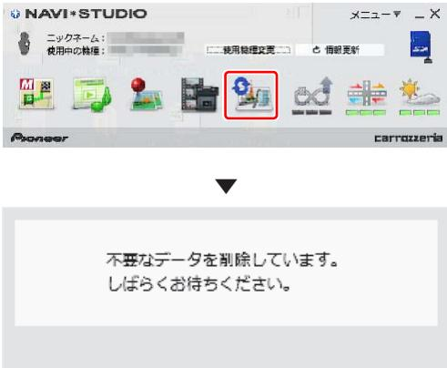
2分割転送の1枚目SDメモリーカード内のデータを削除する場合は、カーナビゲーション本体にて2枚目の更新完了後に、カーナビゲーション本体に1枚目のSDメモリーカードを挿入してください。(ナビ画面上は特に何も反応がありませんが、更新完了の状態をSDメモリーカード内に書き込んでいます。)
