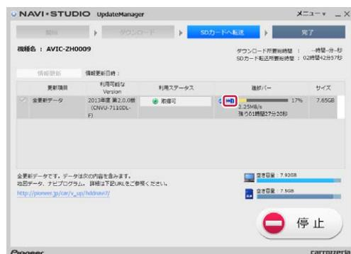
1枚目転送終了後、「SDカード（1枚目）を安全に取り外す」ボタンをクリックしてSDメモリーカードを取り外してください。
