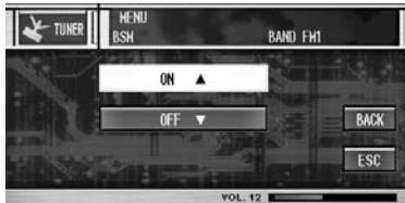
BSM（放送局自動登録）が始まります。登録動作中は、“BSM”が点滅します。登録が完了すると、“BSM”的点滅が終わります。
