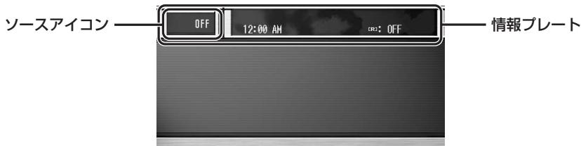
情報プレートの左端には現在選択しているソースのアイコンが表示されます。また、ソースアイコンの右側には、選択したソースに応じて、再生時間やチャンネルなどのさまざまなお情報を表示されます。表示される内容のうち、タイトル切り換えができるものや、一度に表示しきれずスクロールして表示させることができるものには、【DISP】ボタン、【DISP】ボタンを押して操作します。（詳しくは、各ソースの説明をご覧ください。）
