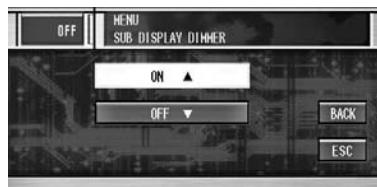
車のライトを点灯すると、サブディスプレイが暗くなるように設定されます。サブディスプレイのディマーをOFFにするには、OFF ▼にタッチします。
