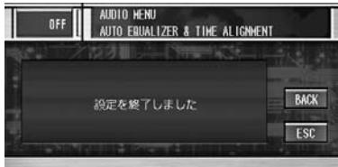
Auto EQ&TAが終わったら、セットした音響特性測定用マイクを取り外し、**ESC**にタッチしてAuto EQ&TAモードを解除します。（ソースがOFFになります。）
