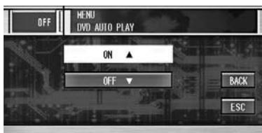
本機にディスクが挿入されたとき、自動再生するように設定されます。自動再生をOFFにするには、**OFF ▼** にタッチします。
