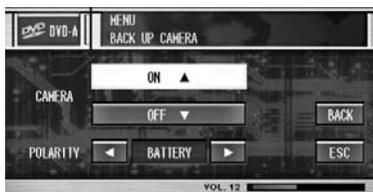
車のシフトレバーをR（リバース）の位置にしたときに、バックカメラの映像がモニターに表示されるように設定されます。
