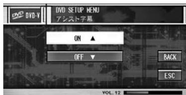
アシスト字幕の表示がONになります。アシスト字幕の表示をOFFにするには、**OFF ▼** にタッチします。
