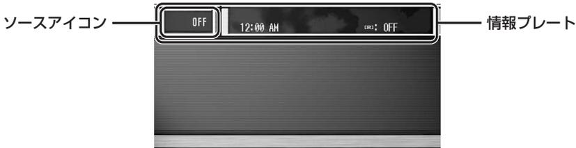
情報プレートの左端には現在選択しているソースのアイコンが表示されます。また、ソースアイコンの右側には、選択したソースに応じて、再生時間やチャンネルなどのさまざまな情報が表示されます。表示される内容のうち、タイトル切り換えができるものや、一度に表示しきれずスクロールして表示させることができるものは、【DISP】ボタン、**[DISP]** ボタンを押して操作します。（詳しくは、各ソースの説明をご覧ください。）
