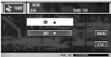
BSM (放送局自動登録) が始まります。登録動作中は、“BSM” が点滅します。登録が完了すると、“BSM” の点滅が終わります。
