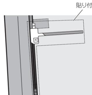
注：十分に汚れ、油膜、水分を拭きとってから貼り付けてください。また、真冬に車内が温かくなると、窓ガラスが結露しますので、十分に乾燥させてからフィルムを貼り付けてください。
