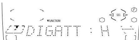
デジタルアッテネーターについてイコライザーカーブの設定（70ページ参照）でレベルを高く設定した周波数の音域が歪むことがあります。イコライザーカーブの設定で音が歪んだように感じたときは、デジタルアッテネーターの設定をLに切り換えてください。
