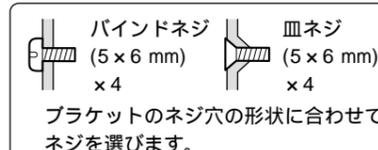
ブラケットのネジ穴の形状に合わせてネジを選びます。
