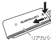
2 期限切れのドコモ UIM カードを矢印の方向に押し出して、取り外します。
