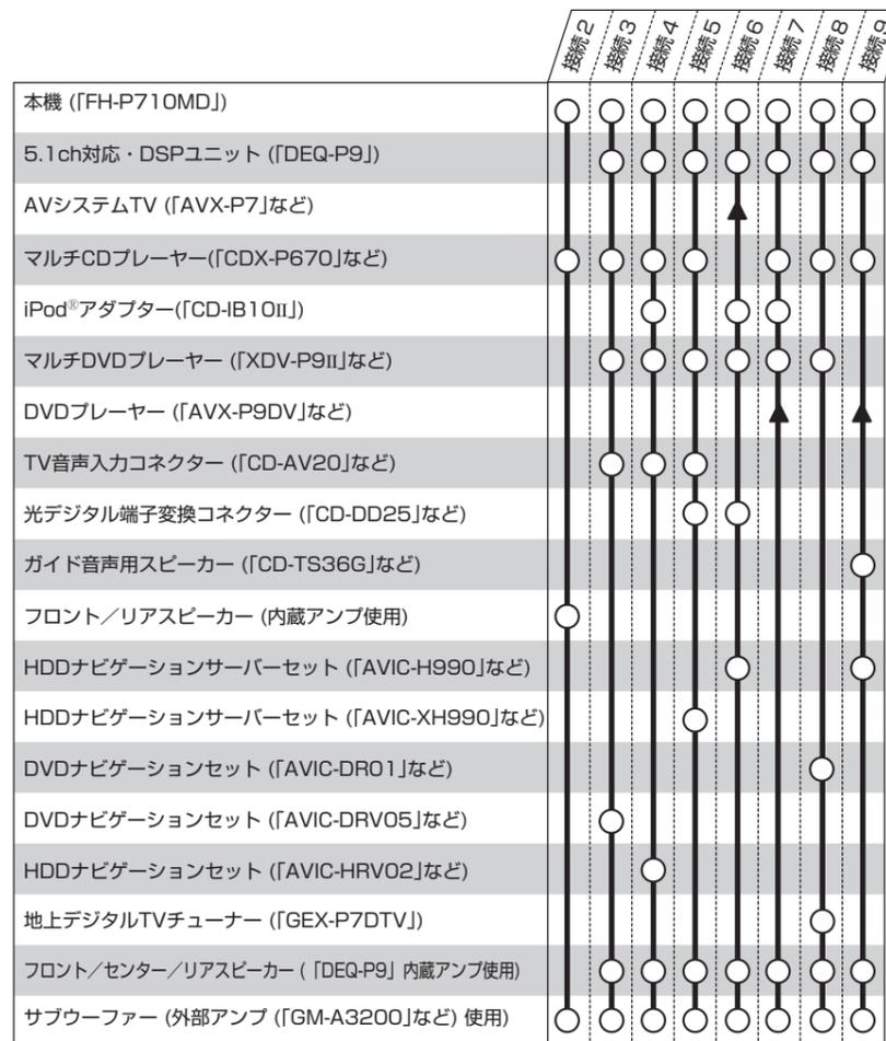
○印：組み合わせで使用することができます。      ▲印：カーステレオの取付位置 (コンソール) にDサイズで3台分の取付スペースがある車種が対象です。
