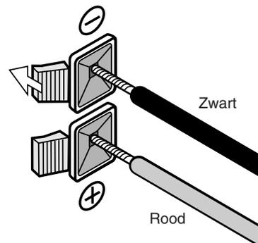
Houd de knop van de luidsprekeraansluiting ingedrukt en steek de kern van het aansluitsnoer in de aansluiting.
