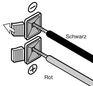
Setzen Sie eine Kabelader des Anschlusskabels ein, während die Taste der Lautsprecheranschlüsse gehalten wird.
