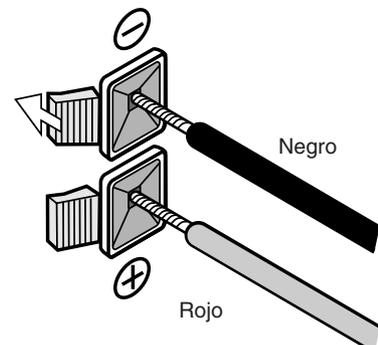
Mientras sostiene el botón de cada terminal de altavoz, inserte un conductor del cable de conexión.
