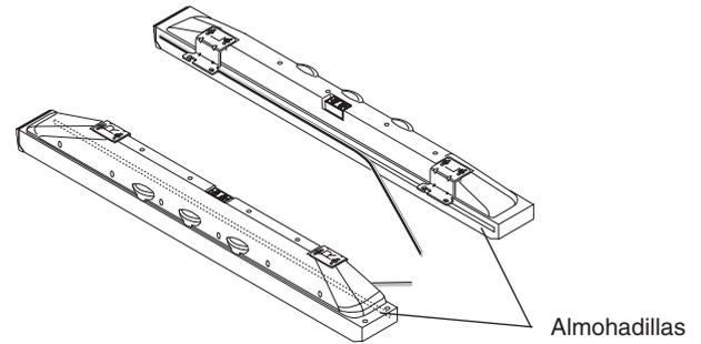
② Apriete parcialmente los tornillos (M4) incluidos en los agujeros para tornillos localizados en la parte superior del monitor.
