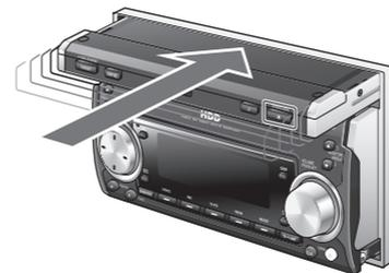
ブレイユニットはモニターが閉じている状態で挿入や取り出しをしてください。挿入の際、立ち上がっているモニターの底面にブレイユニットが接触し落とすと、パネルやブレイユニットが破損する恐れがあります。
