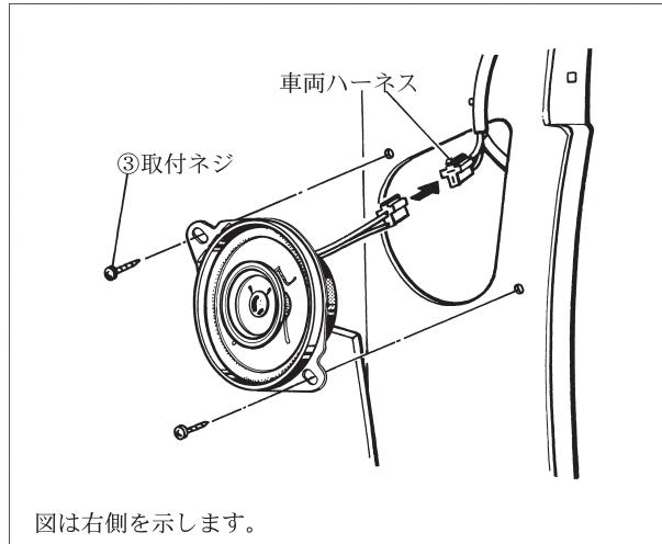
②コードと車両ハーネスを接続し、③取付ネジでスピーカーを取り付けます。
