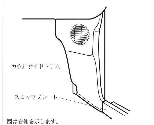
スカッフプレートを外し、次にカウルサイドトリムを外します。
