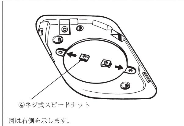
開口穴に④ネジ式スピードナットを挿入します。
