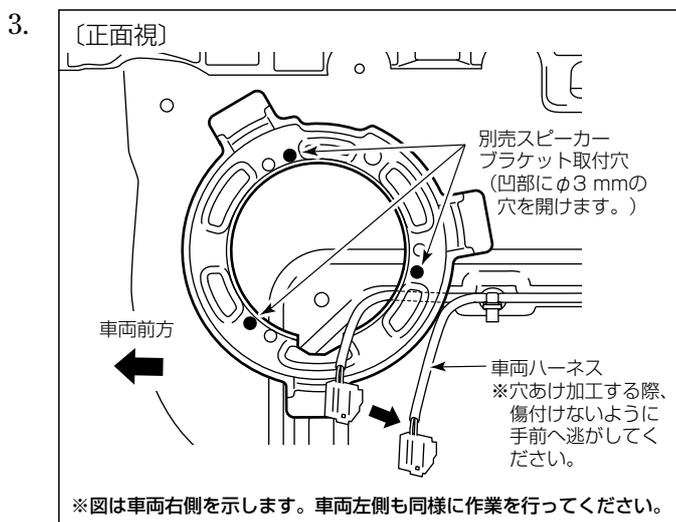
インナーパネルの別売スピーカーブラケット取付穴(凹部)に、ドリルおよびドリルビット(φ3 mm)を使用して穴を開けます。
