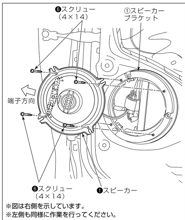
(10) ①スピーカーを⑥スクリュー (4×14) (4本) で ①スピーカーブラケットに取り付けてください。
