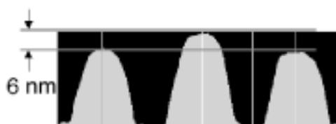
図8 記録済みディスク記録膜の AFM 測定断面表示像
