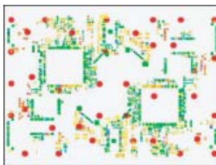
図10 基板上的はんだ量分布と下支えピンの関係
