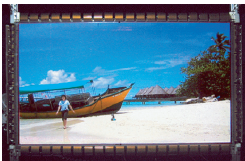
図 11 ASSC 構造パネルを用いた 50 型試作品と、表示画像
