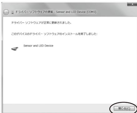
「ドライバー ソフトウェアが正常に更新されました。」と表示されます。「閉じる(C)」をクリックします。インストールは完了となります。
