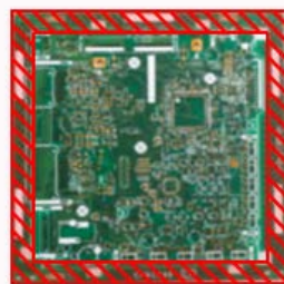
プリント基板の改善例：捨て基板（赤斜線部分）を無くしました。
