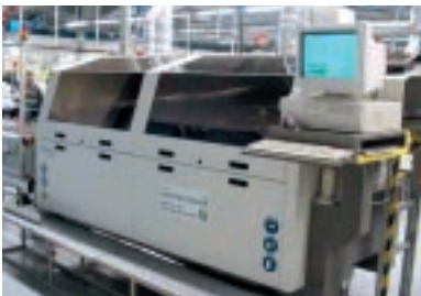
ボルトガルに導入されている 無鉛はんだづけ装置
