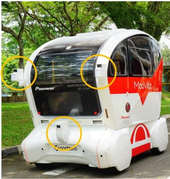
【パイオニア製「3D-LiDAR センサー」が搭載された自動運転シャトルバス】
