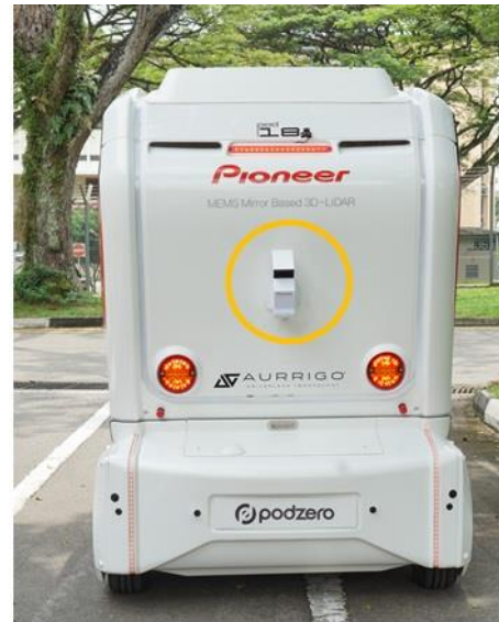
【パイオニア製「3D-LiDAR センサー」が搭載された自動運転シャトルバス】
