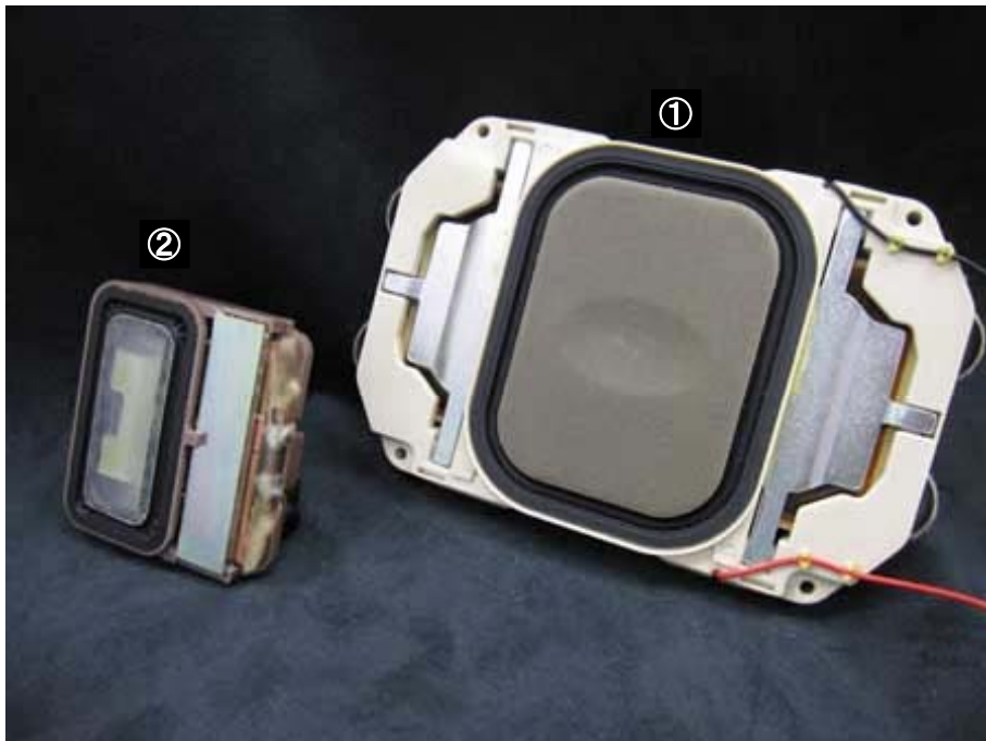
①75X57mm(丸型 87mm 相当) の片面駆動 HVT ユニット
