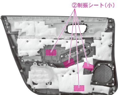
純正の吸音材がついている場合、吸音材をめくって内張りに制振シートを貼り、吸音材を元に戻します。
