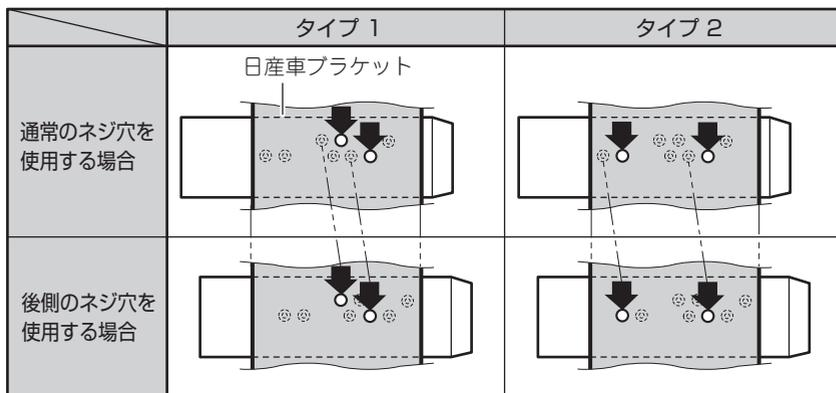
取り付けスペースの奥行きが少ないなどの理由で「後側のネジ穴を使用する場合」には、加工するなどして、必ず片側2カ所ずつビス止めしてください。片側1カ所止めの場合、音飛びや現在地を正しく表示できなくなるなどの原因となります。また、車種によっては窓パネルの加工なども必要となりますので、商品の取り付けにあたっては、お買い上げの販売店にご相談ください。
