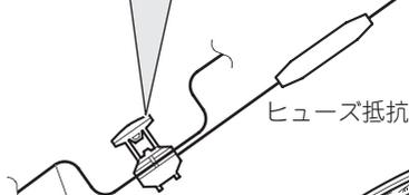
バックランプ(シフトレバーがリバース [R] のときに点灯するランプ)の位置を確認し、トランク内からバックランプのリード線を取り出します。
