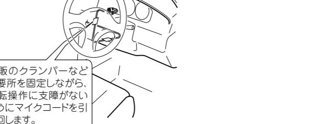
市販のクランパーなどで要所を固定しながら、運転操作に支障がないようにマイクコードを引き回します。
