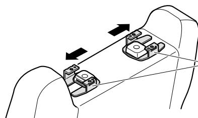
コの字ブラケットの開いた方が外向きになるように、スライドして取り付けます。
