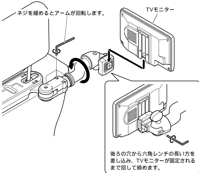
ゆるめたネジは、調節後しっかりと締め直してください。六角レンチで締めても緩く感じる場合は、次のようにいったん取付金具からデタッチ部分を取り外し、中のネジを六角レンチで締めてください。
