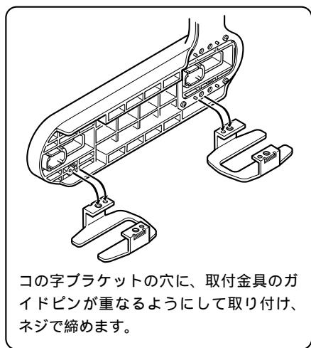
コの字ブラケットの穴に、取付金具のガイドピンが重なるようにして取り付け、ネジで締めます。
