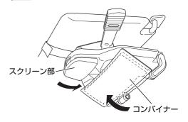
スクリーン部とコンバイナーはしっかり と閉じてください。コンバイナーを閉じ ずにサンバイザーを開くと、車両やコン バイナーに傷を付けることがあります。
