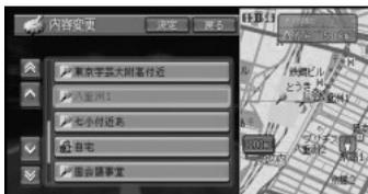
**ヒント** リストの並び順を自車位置から近い順、よみ(50音順)、2Dマーク(選択リスト順)、呼出日時(新しい順)に変更することができます。並び順を変えるには、リスト中の **並び替え** を選び、ポップアップメニューから好みの並び順を選択します。
