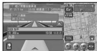
▲をタッチするかジョイスティックを上に乗ると、先の施設情報が表示されます。「ナビ」ボタンを押すと現在地に戻り、現在向かっている施設を表示します。
