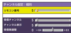
6 で「受信チャンネル」を選び、 で希望の受信チャンネルを設定する。
