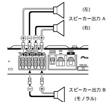
本機にはRCA入力端子とスピーカー入力端子の2種類の入力端子がありますが、両方同時に使用しないでください。両方に接続して使用すると、故障する恐れがあります。
