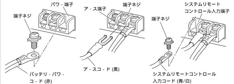
バッテリーなどの配置によりバッテリーパワーコードを高温となる場所に配置する場合は、RD-226 (別売) に付属のコルゲートチューブでバッテリーパワーコードを保護し配置してください。
