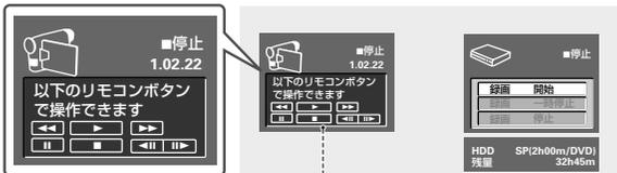
DV取り込み画面では、本機のリモコンのボタンをデジタルビデオカメラの操作に使用します。上記のボタンを使用することができます。
