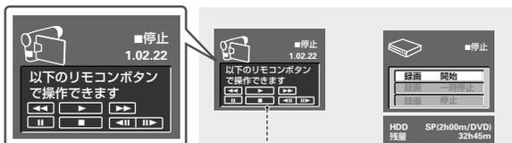
DV 取り込み画面では、本機のリモコンのボタンをデジタルビデオカメラの操作に使用します。上記のボタンを使用することができます。
