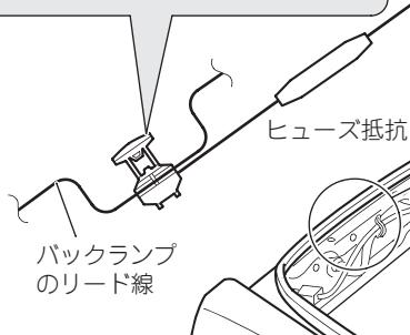
パックランプ(シフトレバーがリバース [R] のときに点灯するランプ)の位置を確認し、トランク内から、パックランプのリード線を取り出します。
