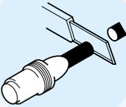
② 切り取ったケーブルの芯線とアミ線を出します。このとき、芯線とアミ線の寸法はアンテナ端子の形に合わせます。
