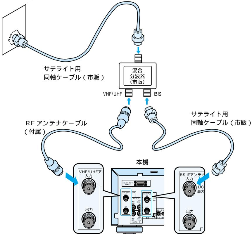
分波器や衛星用同軸ケーブルを購入される前に、ご使用になるアンテナ端子がVHF/UHF/BS混
