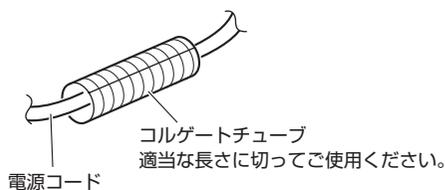
バッテリーなどの位置によって、高温となる場所にバッテリーパワーコードを配置しなくてはならない場合は、RD-228 (別売) に付属のコルゲートチューブでバッテリーパワーコードを保護してください。
